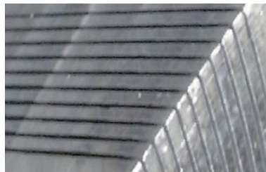
※従来の複数枚切断技術に比べて、高効率、短時間、低コスト及び高品質で切断が可能となりました。写真は2インチ10枚（直径約50mm）の切断例です。
