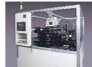
PDP点灯検査装置
